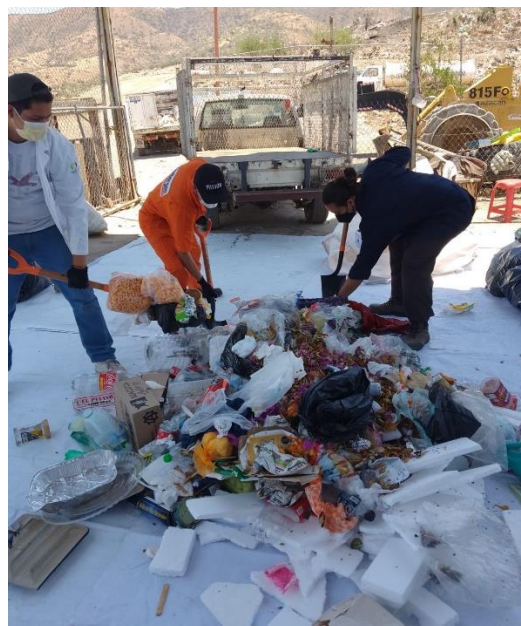
Fig. 44. Procesamiento y homogenización de muestras. Fuente: Elaboración propia.
